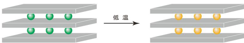
トポケミカル反応では、出発系と生成系で組成は変化するが、構造はほとんど変化しない。そのため、物質設計という点では非常に有効な合成法である。この反応では、結晶格子中のイオン結合など、比較的弱い結合をもつ部分のみが反応し、共有結合性が強い部分は基本骨格として残る。
