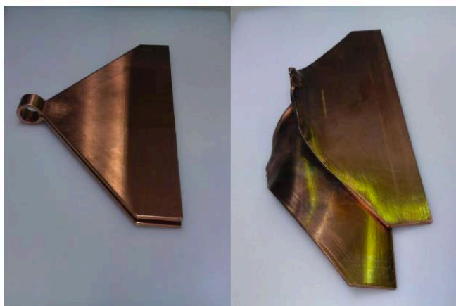
図4. 一巻きコイル法で用いる内直径が14 mmの磁場発生コイルの写真。左は磁場発生前、右は磁場発生後。
